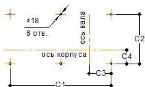
Схема расположения отверстий под фундаментные болты
