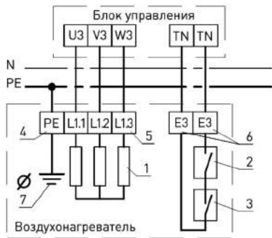
Подключение нагревателей мощностью до 13 кВт (1 ступень, 20 А / 3х380В) до 17 кВт (1 ступень, 25 А / 3х380В) до 20 кВт (1 ступень, 30 А / 3х380В)
