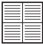
ОРК1 – параллельное расположение направляющих воздушного потока
