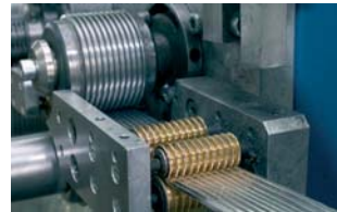
Цех изготовления гибких воздуховодов
