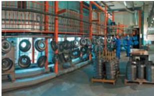
Цех порошковой покраски
