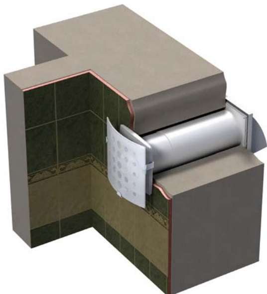
Вытяжка воздуха напрямую через стену
