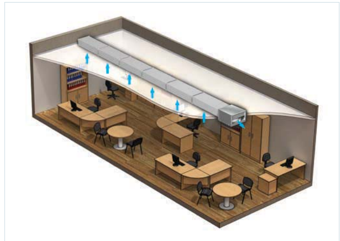
Вариант применения вентилятора ВКПФИ в офисном помещении
