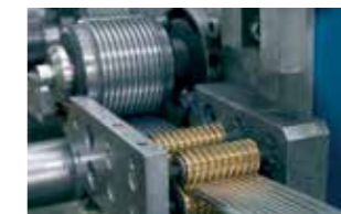
Цех изготовления гибких воздуховодов
